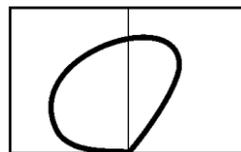
Тот же годограф, полученный при сканировании отнесенным от поверхности датчиком, ясно указывает на то, что объект железный
