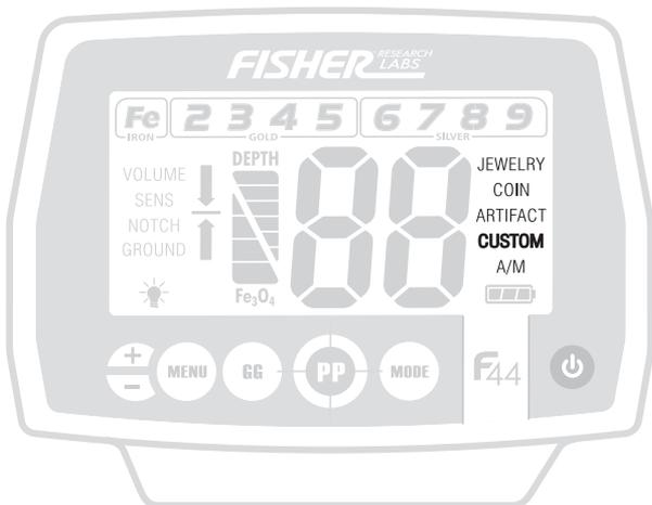
Активный режим выделяется жирным шрифтом. Для изменения селективного игнорирования в каждом из режимов используется функция NOTCH. В режиме ALL METAL функция NOTCH не работает.
