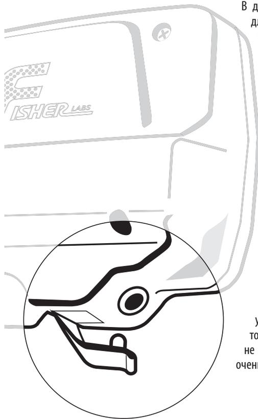
В данном металлоискателе используется разъём для наушников диаметром 6,25 мм (1/4 дюйм-ма). Он может работать с любыми стереонаушниками (не входят в комплект поставки) с таким разъёмом. Когда подключены наушники, внешний динамик отключается. Работа с наушниками увеличивает срок работы от батареи, и звуковой сигнал прибора не мешает окружающим. Помимо этого, наушники способствуют лучшей слышимости слабых сигналов.
