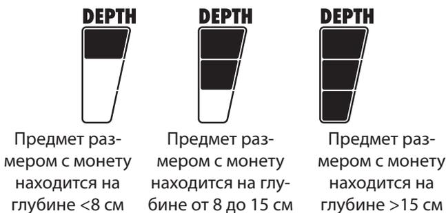
Другие объекты также регистрируются на трёхсегментном индикаторе глубины, однако показания будут относительными. Например, свечение всех трёх сегментов может означать монету на глубине 23 см, но может означать и очень крупный объект на метровой глубине. Для получения более надёжной информации используйте индикатор глубины в сочетании с индикатором категории объекта.
