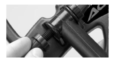
3. Вставьте верхнюю штангу в нижнюю штангу, а затем собранный таким образом узел вставьте в раму пульта управления детектора АСЕ, нажав две кнопки и соединив штангу с узлом корпуса. Отрегулируйте наиболее удобную для работы длину собранного узла.
