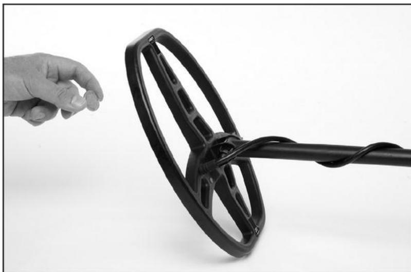
После того, как вы определили, как ваши тест-объекты отображаются на **Target ID** при воздушных испытаниях, проверьте их же в почве. Закопайте ваши предметы на отмеченную глубину, чтобы составить «опытное поле». Отметьте, как прочитываются разные цели в зависимости от того, лежат ли они в земле плоско или под разными углами.
