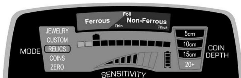
На рисунке вверху *EuroACE* работает в режиме RELICS, с двумя отключёнными пикселями дискриминации железа. Гвоздь, показанный на **Рис. 1 на стр. 22**, регистрируется над третьим пикселем. Эти железистые объекты могут быть исключены из нахождения при использовании кнопки **✓/✗**, выключив третий слева пиксель.
