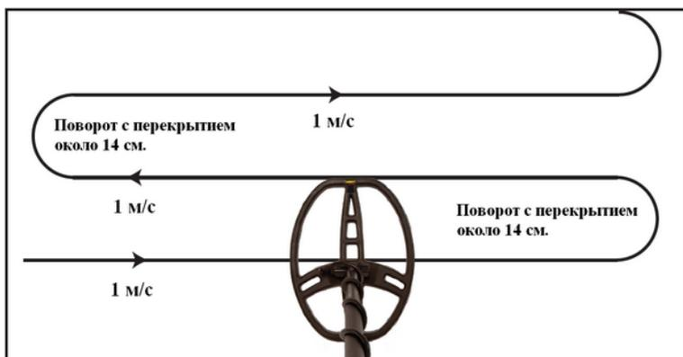
Чтобы полностью обследовать какую-либо площадь, каждый последующий взмах должен перекрывать предыдущий на половину размера катушки (подобно змейке). Таким образом избегаются пропуски на максимальной глубине.
