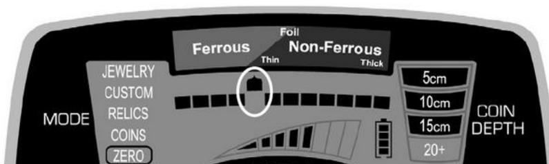
Второй метод изменения меток дискриминации включает применение только кнопки  $\checkmark/\times$ . Когда ненужная металлическая цель определена на слух во время поиска, просто нажмите кнопку  $\checkmark/\times$ , чтобы создать метку, где курсор **Target ID** просигналил о наличии мусора. В следующий раз, когда *EuroACE* опять встретит тот же мусор, он не даст звукового сигнала.
