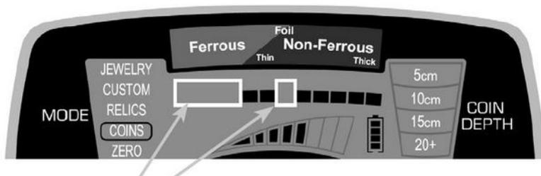
В режиме COINS четыре пикселя под железом и один пиксель фольги отключены.
