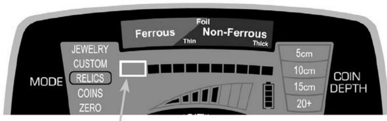
В режиме RELICS отключены два левых пикселя дискриминации.
