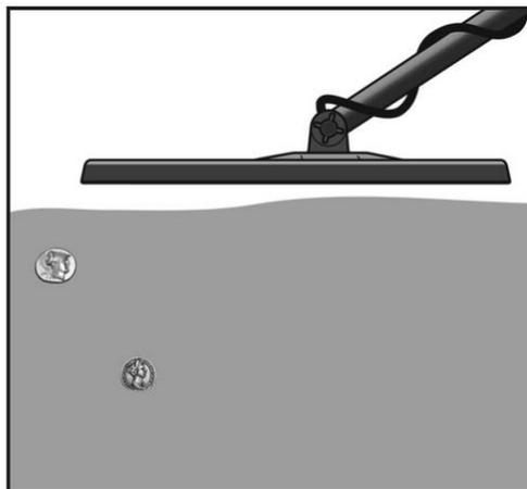
Вы можете изменить эту технику точной локализации цели, чтобы цель оказывалась под задней стороной DD-катушки; в этом случае катушку надо двигать от себя. Звуковые сигналы и сигналы на ЖК-мониторе покажут положение цели сразу за задней частью поисковой катушки.
