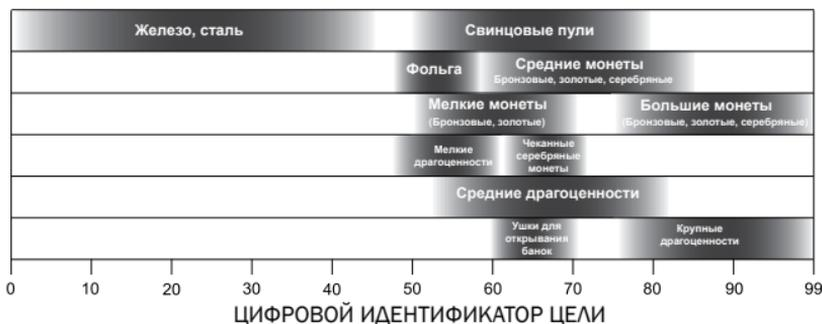
Показания цифрового идентификатора цели могут значительно различаться в зависимости от размеров и толщины цели, так как небольшие тонкие предметы не обладают электрической проводимостью, характерной для предметов, имеющих большую толщину. Также на погрешности показаний цифрового идентификатора цели могут влиять минерализация грунта.
