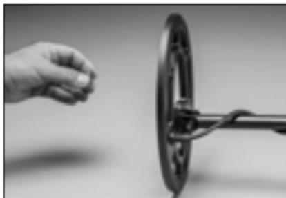
Затем выполните несколько испытаний оборудования по поиску объектов в грунте. Создайте "пробный участок" поисков, закопав несколько металлических предметов на определенной глубине. Отметьте, как считывается сигнал объектов в зависимости от положения: горизонтального или под углом.
