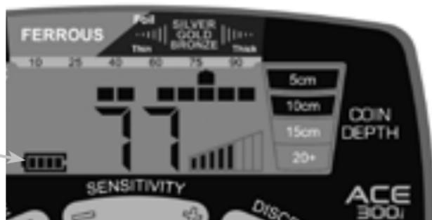
Четыре сегмента шкалы указывают на полный заряд батарей. Замена батарей выполняется, когда на индикаторе остается только один сегмент. Металлоискатель сохраняет полную работоспособность до истечения лимита заряда батарей. Могут использоваться перезаряжаемые батареи NiMH, хотя такие батареи отличаются меньшим временем действующей зарядки. Батареи, в зависимости от типа и качества, обеспечивают от 20 до 40 часов эксплуатации металлоискателя.
