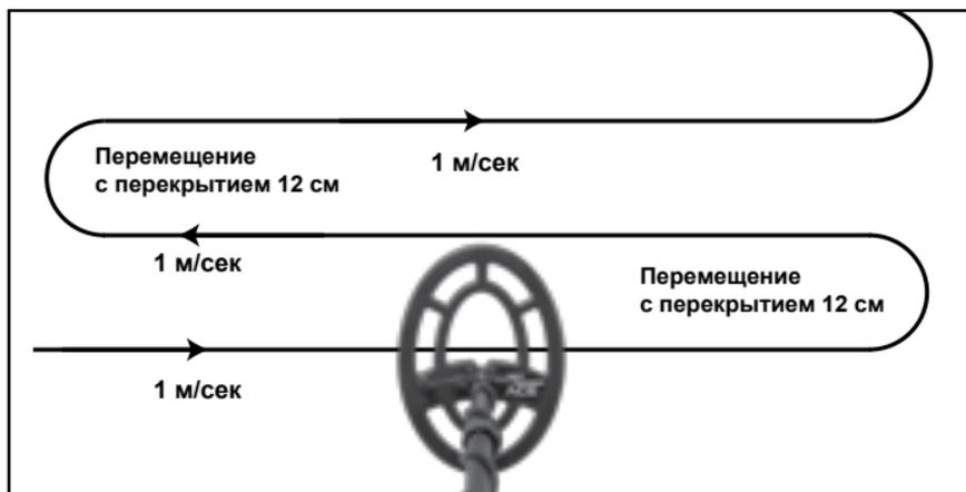
Для полного обследования участка поиска каждый последовательный взмах катушки должен перекрывать предыдущий на половину длины катушки (около 12 см). Перемещайте катушку по прямой линии или по небольшой дуге со скоростью около 1 м/сек.
