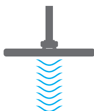
Вид спереди самого сильного профиля сигнала катушки Double-D.
