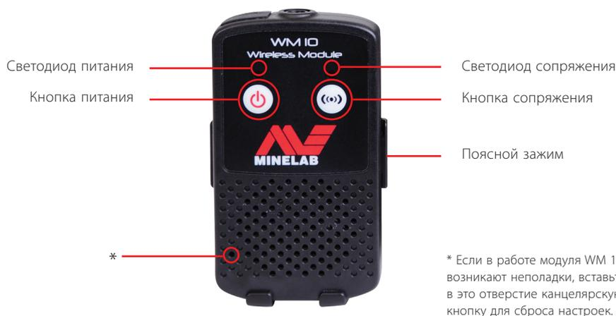
\* Если в работе модуля WM 10 возникают неполадки, вставьте в это отверстие канцелярскую кнопку для сброса настроек.
