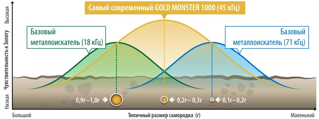
Сравнения чувствительности металлоискателя приведены только для общего представления. Реальная производительность будет зависеть от размера самородка, настроек металлоискателя и условий грунта.
