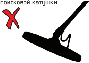
Неправильный угол наклона поисковой катушки
