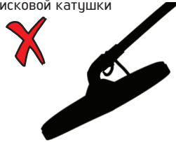
Неправильный угол наклона поисковой катушки
