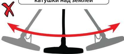
Неправильный проход катушки над землёй
