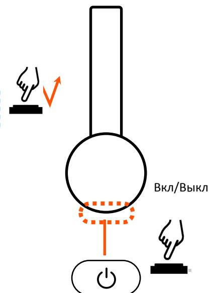
После включения Quest 40 и беспроводных наушников нажмите кнопку беспроводного сопряжения на правой стороне блока управления, чтобы активировать связь. Наушники будут сопряжены. Если они потеряли сопряжение, поднесите из к блоку управления на 13 см и один раз нажмите кнопку включения
