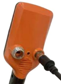
Снимите влагозащитную и пылезащитную крышку, чтобы получить доступ к отверстиям. Установите ее на место, чтобы избежать попадания жидкости или грязи.
