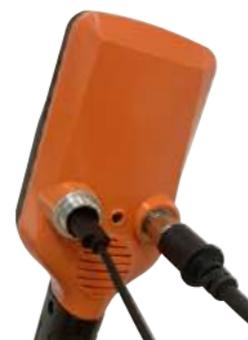
Подключите прилагаемый кабель USB-C к настенному зарядному устройству с USB-портом. Индикатор заряда батареи перестанет мигать после полной зарядки. Для полной зарядки детектора требуется около 4 часов.
